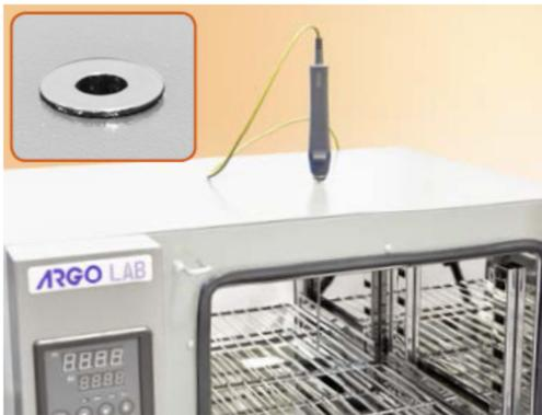
Il sensore PT100 installato all'interno della camera garantisce il controllo preciso della temperatura.
